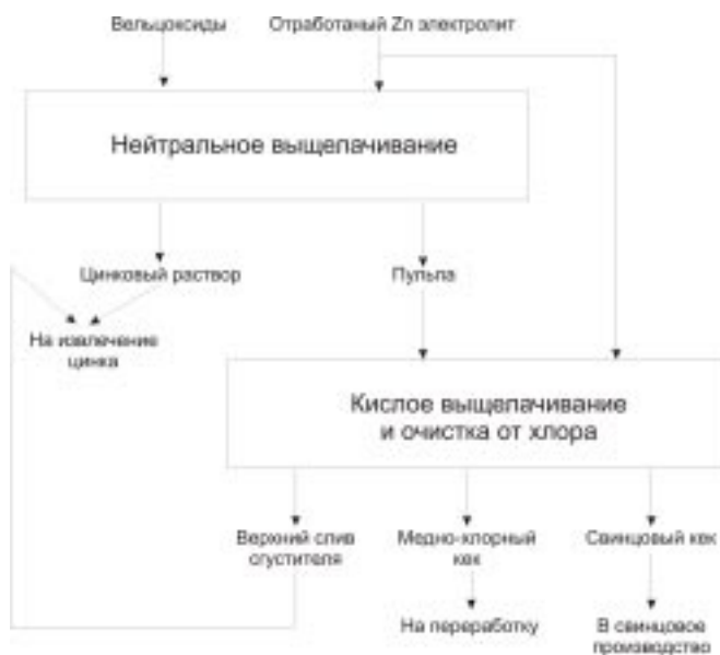
Рис. 3. Технологическая схема гидрометаллургической переработки вельцооксидов
